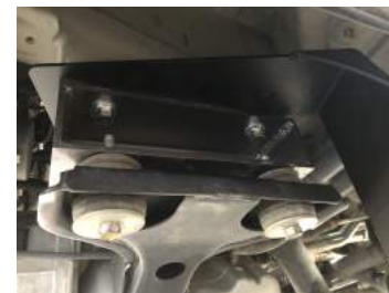
③エンジンメンバーサイドの後ろ側のボルトを外してフロント用のブラケットを差し込んで仮止めします。（長穴の方です）この時まで前側のボルトは外さないでください。
