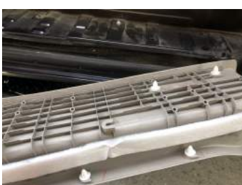
⑧樹脂パネルを元に戻す前に、ボルト固定の際に利用したクリップ留め穴の部分のクリップを外しカッターナイフなどで、クリップ留めのツメ部分を切り取ります。 ⑨樹脂パネルを元に戻したら、取り付け個所のブラケットに、ステップ本体と縞板を付属のM8キャップボルトで固定して完成です。
