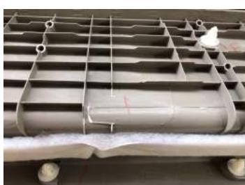
⑧樹脂パネルを元に戻す前に、ボルト固定の際に利用したクリップ留め穴の部分のクリップを外しカッターナイフなどで、クリップ留めのツメ部分を切り取ります。 ⑨樹脂パネルを元に戻したら、取り付け個所のブラケットに、ステップ本体と縞板を付属のM8キャップボルトで固定して完成です。
