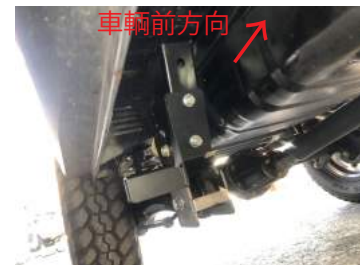
①リア側のブラケットを、リアアームフレーム部の穴を利用して固定します。
