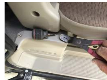
③エンジンメンバーサイドの後ろ側のボルトを外してフロント用のブラケットを差し込んで仮止めします。（長穴の方です）この時まで前側のボルトは外さないでください。
