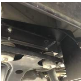
④後ろ側を仮止めしたら、前側のボルトを外します。
