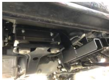
⑤ブラケットの前側も差し込んで、ボルトでしっかり固定します。 先に緩めていたところも締めなおします。
