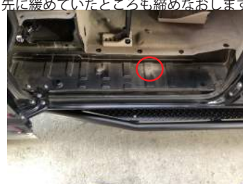
⑦赤マルノ所のクリップ留め用の穴を利用して、中央用のブラケットを固定します。
