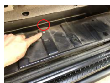
⑦赤マルノ所のクリップ留め用の穴を利用して、中央用のブラケットを固定します。
