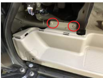
④後ろ側を仮止めしたら、前側のボルトを外します。
