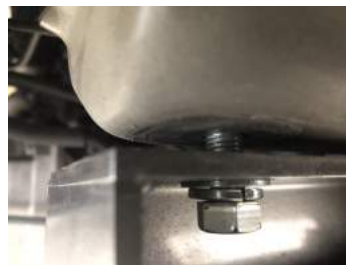
②エンジンメンバーサイドのボルト（赤マル）をメンバーが落ちないように十分注意してブラケットのプレートが差し込める程度の隙間をつくる。 リフトアップブラケットが装着されている場合は、フレーム側のボルトを緩める。（青マル）
