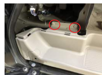
⑥後部席の室内のステップ部の樹脂製トリムを外します。
