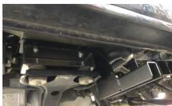
②エンジンメンバーサイドのボルト（赤マル）をメンバーが落ちないように十分注意してブラケットのプレートが差し込める程度の隙間をつくる。リフトアップブラケットが装着されている場合は、フレーム側のボルトを緩める。（青マル）
