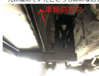
⑦赤マルの所のクリップ留め用の穴を利用して、中央用のブラケットを固定します。
