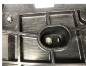
⑦赤マルの所の純正ボルトを外し、付属のM6ボルトと交換します。
