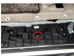
⑦赤マルの所の純正ボルトを外し、付属のM6ボルトと交換します。
