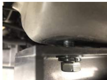
②エンジンメンバーサイドのボルト（赤マル）をメンバーが落ちないように十分注意してブラケットのプレートが差し込める程度の隙間をつくる。リフトアップブラケットが装着されている場合は、フレーム側のボルトを緩める。（青マル）
